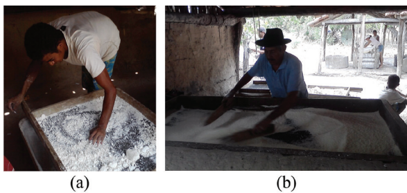
Figura 5: Processo de peneiramento do resíduo prensado (a) e resíduo peneirado sendo aquecido em forno artesanal (b).
