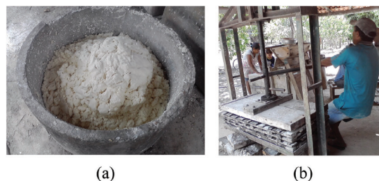
Figura 4: Resíduo que fica na rede durante o processo de filtração (a) e sendo prensado para diminuir o excesso de água (b).
